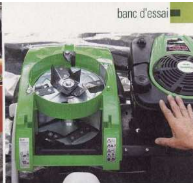
Changement de grille sur l'Eilet Maestro (à gauche). Deux chambres de broyage sur le gros Viking GB 460 (ci-dessus).
