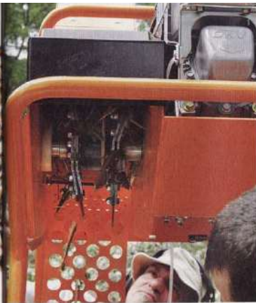
Changement de grille sur l'Eilet Maestro (à gauche). Deux chambres de broyage sur le gros Viking GB 460 (ci-dessus).
